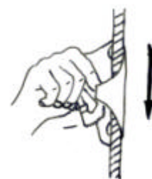
Abbildung 142: Verschieben einer Steigklemme entgegen der Klemmrichtung
