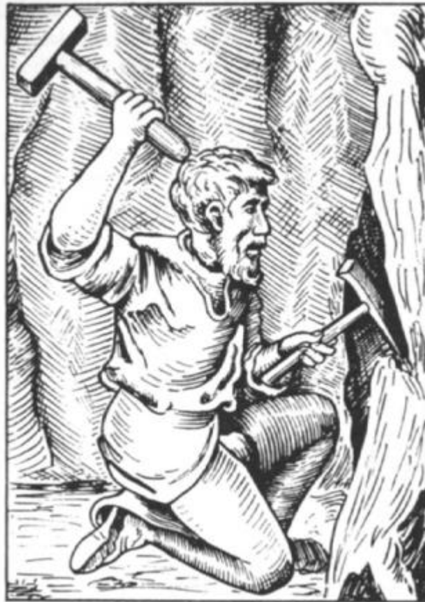
Abbildung 16: Arbeit mit Schlegel und Eisen
