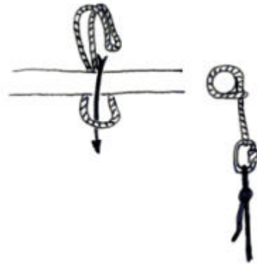
Abbildung 157: Legen einer seitlich nicht verschiebbaren Aufhängung um einen natürlichen Sicherungspunkt
