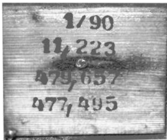
Abbildung 38: Polygonpunkttafel und Lage der Tafeln auf einem Polygonzug
