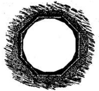
Abbildung 97: Die historische „Vieleckzimmerung“ als Vorläufer des Polygonausbaus aus: [31]
